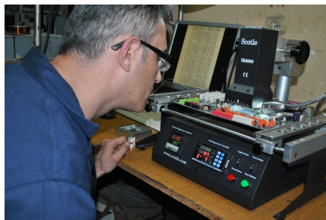
Foto: stația de reballing Scottie IR6000 la lucru, P.c.c. Strâmbu Ionuț fiind un bun cunoscător și utilizator al acesteia
