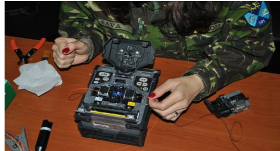
Fibra optică în timpul procesului de sudură
