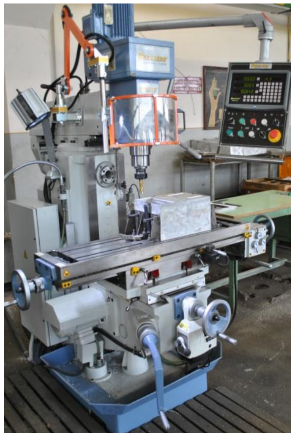
Freză modernă, la care poziționarea pe axele x, y și z este indicată pe afișor.
